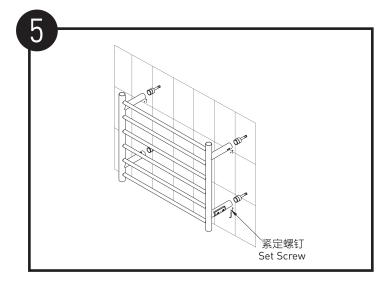
将产品主体套入堵头,使用紧定螺丝将产品安装在堵头上,并上紧。
