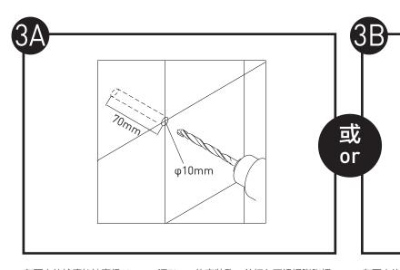
在画出的轮廓处钻直径10mm,深70mm的安装孔,并打入不锈钢膨胀螺 钉。
