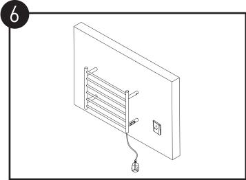
安装完成,确认产品已经安装牢固,电源线正确连接后,方可通电使用 产品。
