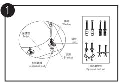
将膨胀螺母、支架、垫片,螺栓装入坐便器安装孔。
