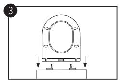
在安装盖板时,确保支座杆与盖板后端的安装孔对准。小心 轻放安装到位(会听到"咔"的一声)
