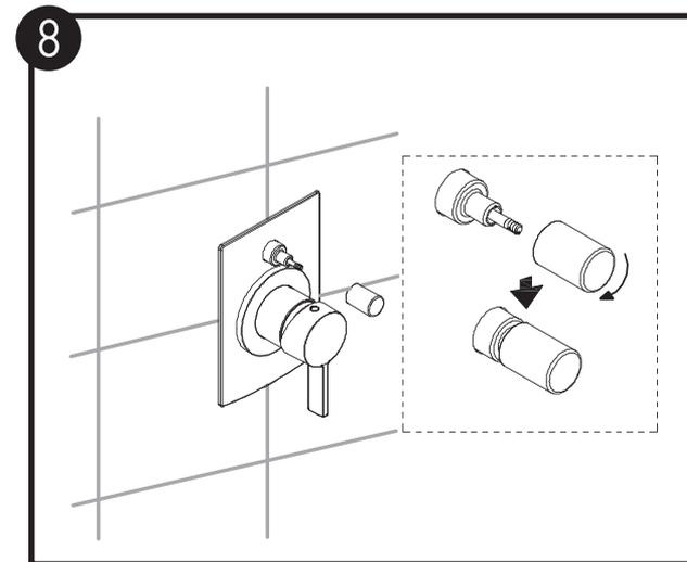
将提拉头直接拧紧在提拉杆上。
