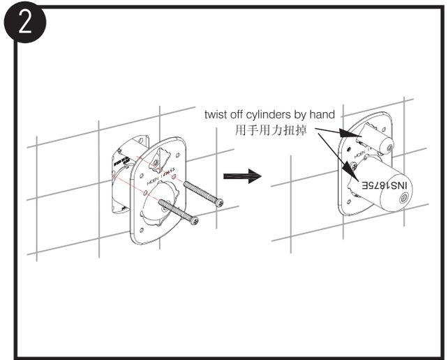
将上一步骤中拆出来的螺钉重新上紧并压紧不锈钢板；然后用力摘除阀体组件中的圆形塑料保护壳。
