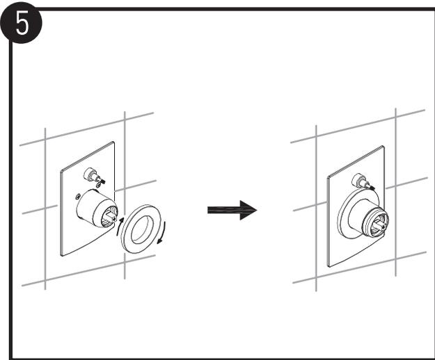
将面板盖平滑穿过阀体套，旋转面板盖使其固定在面板上直至贴紧。
