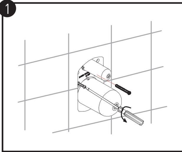
请先用螺丝刀拆出护壳上面的两颗螺钉，请保留螺钉，后面安装面板需装回这两颗螺钉。
