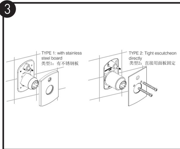
将面板穿过阀体套并贴紧墙面；对于类型2的面板，请用两颗螺钉固定面板到墙面；如有必要请涂上适量的密封胶在面板与墙体之间。
