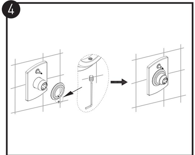
将面板盖平滑穿过阀体套贴紧面板，用螺钉将其固定在阀体套上，保持螺钉在下方。
