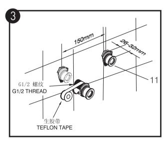
用封管胶带缠上弯头(10)有螺纹的一头,然后接上供水管.要有足够的生胶带以密封弯头与出水管间的连接处。调整两弯头位置水平,相距相距150mm,并凸出墙面26-32mm。
