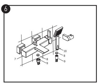
确保花洒软管(9)的两端都带有密封垫片(8)。将花洒软管(9)的一端连接花洒(10),另一端连接阀体(7)。 打开冷热水,检查弯头接口及软管两端是否漏水。
