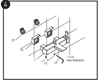
确保之字接头内侧的O型圈(15)装好,将法兰罩(12)套在龙头(7)上,并使法兰罩(12)紧贴龙头(7)背面。把龙头装在接头上,并继续推龙头直至碰到之字接头并稳固.装上螺钉(13),再用六角匙(14)上紧。然后把法兰罩(12)推向墙面使其贴紧。
