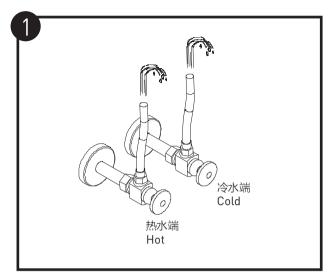
安装前,请务必先清除墙体预埋水管内的杂质及污泥,以免影响出水功能! 在钻孔和安装过程中请务必注意安全。 热供水管在左边,冷供水管在右边。
