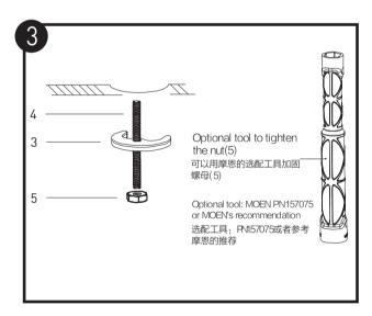
将安装固定块(3)套进固定螺杆(4),用固定螺母(5)将垫块锁紧;分别连接冷热供水软管与进水管。 装好后打开供水开关检查是否有漏水。
