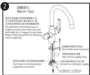
将三条供水管穿过台面的安装孔,确保阀体底部有一个O型圈(这个O型圈是用于防止台面的水渗漏到台面下),当台面的孔较小时,如有必要可以拧开其中一条进水管以方便穿过孔,然后从台面下穿过孔装回龙头;将龙头放在正确的位置上(MOEN标识朝前方)。
