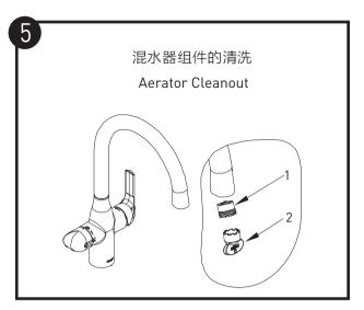
定期用安装工具(2)旋出混水器组件(1),清洗掉杂质后再装回去。
