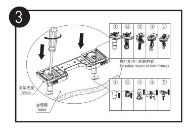
调节好固定块、调节片的方向,将两个膨胀头对准坐便器的两个安装小孔后插入,并用螺丝刀预紧(旋紧螺母)。
