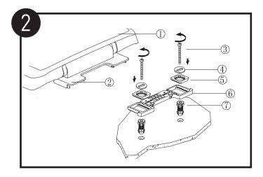
取出安装配件包,按照图示顺序将螺丝③、调节片④、固定块⑤安装在支架底座的安装槽中,然后套上膨胀头,适当锁紧。
