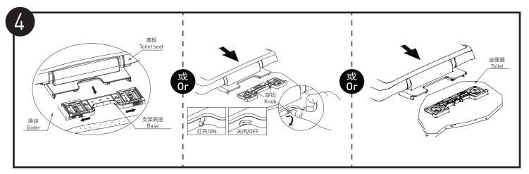
将盖板安装并调节好盖板的位置,然后拆除盖板,接着拧紧螺钉将支架底座完全固定在坐便器上,最后再次将盖板装上。
