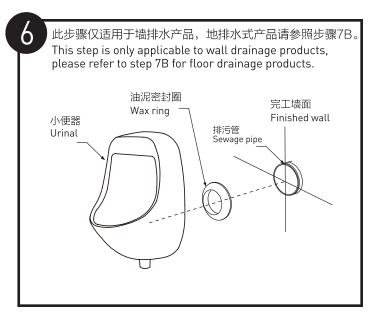
撕开油泥密封圈上的保护纸,将油泥密封圈粘在小便器排污口上, 对准排污管后压入,确保密封良好。
