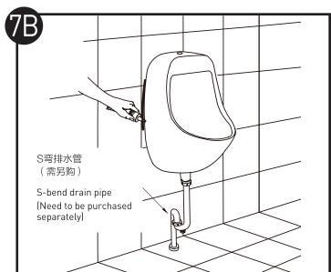
先安装S弯排水管,将密封圈与小便器排污口连接的地方涂抹硅胶后,把小便器安装在刮片上。然后在小便器与墙面接触的边缘,涂抹硅胶以此填平接触缝隙。
