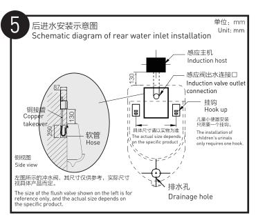
将挂块安装在墙上,排污孔两端的孔敲入膨胀螺栓。
